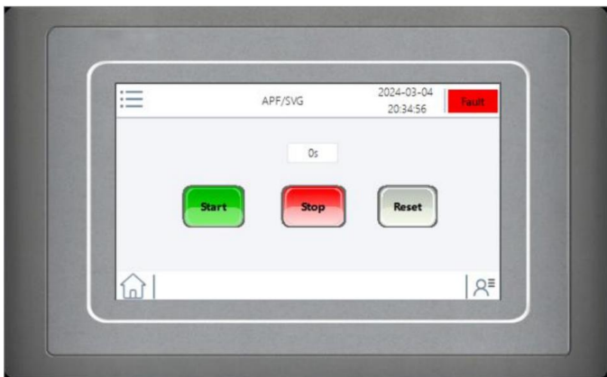
Rysunek 2-20 Włączanie/wyłączanie i resetowanie
