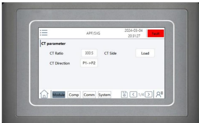
Rysunek 2-9 Ustawienia parametrów CT O
