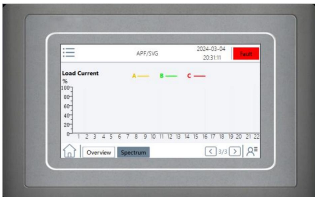
Rysunek 2-7 Diagram kolumnowy harmonicznych prądu obciążenia
