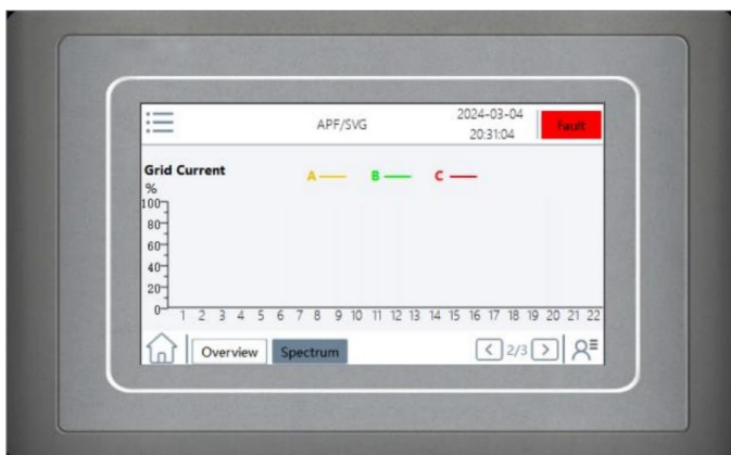
Rysunek 2-6 Diagram słupkowy harmonicznych prądu sieciowego
