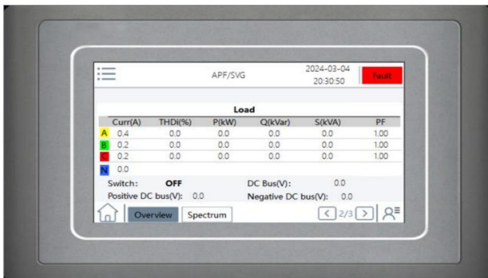
Rysunek 2-3 Strona danych po stronie obciążenia
