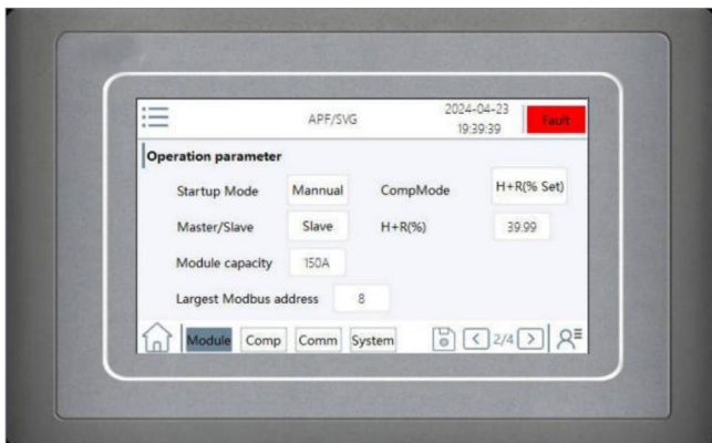
Rysunek 2-10 Ustawianie parametrów roboczych
